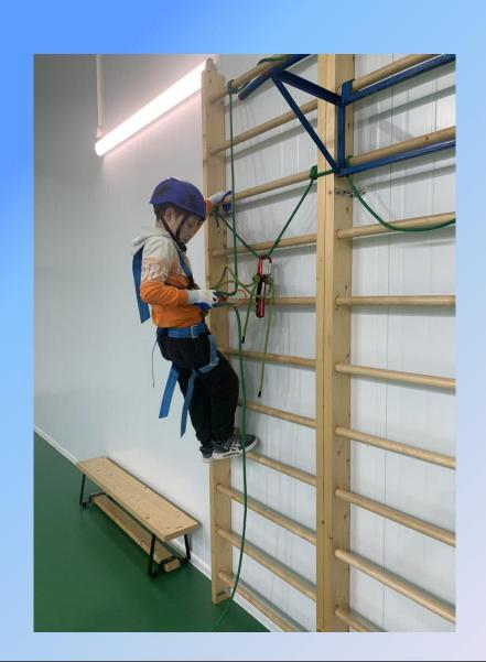
Тренажер для отработки на земле техники перестегивания с приспособления подъема «Жумар» на спусковое устройство «Восмерка» через ус самостраховки.
